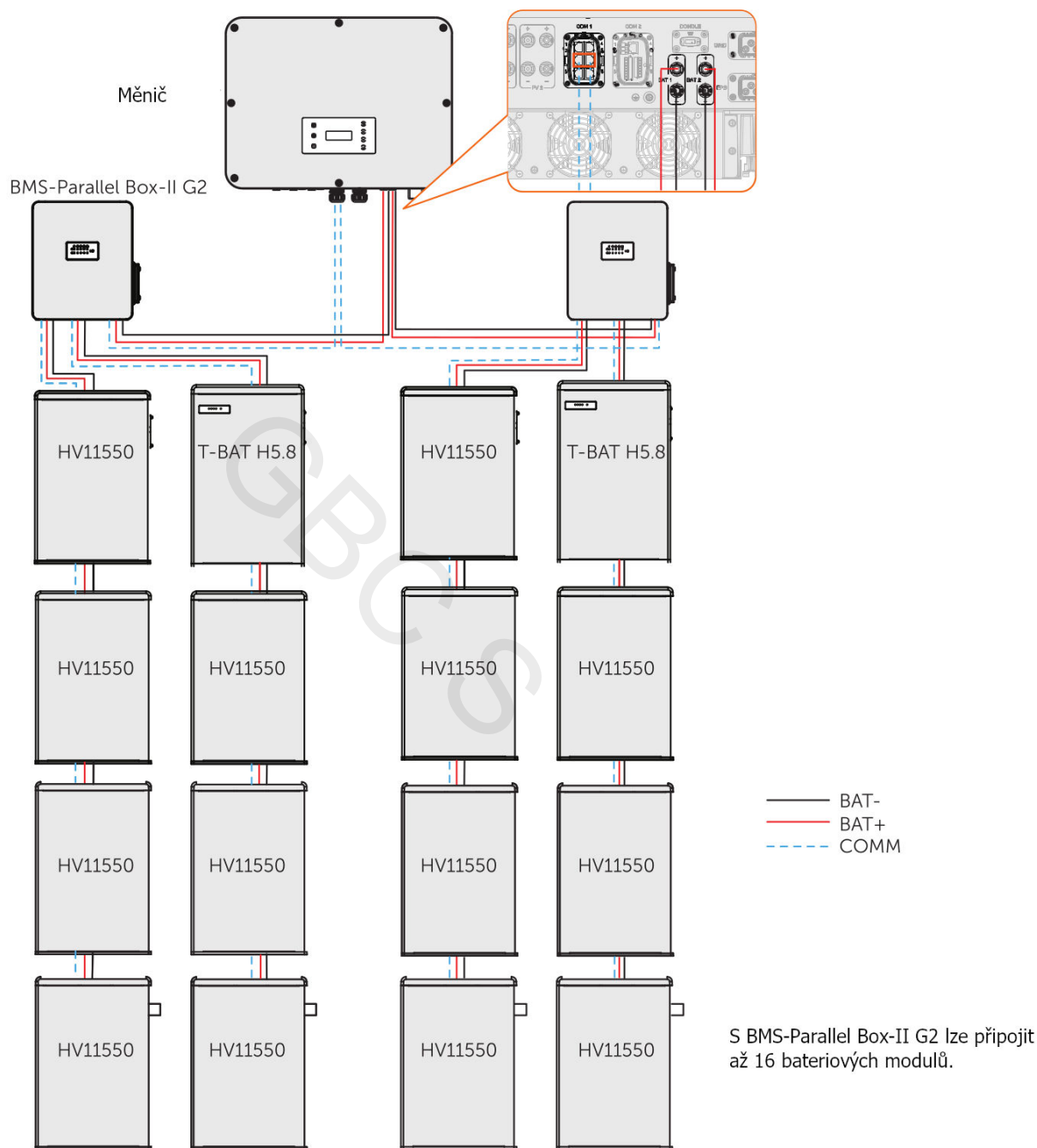
Připojení baterie s BMS-Parallel Box-II G2
